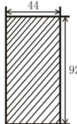
开孔尺寸 $44^{+1} \times 92^{+1}\text{mm}$
