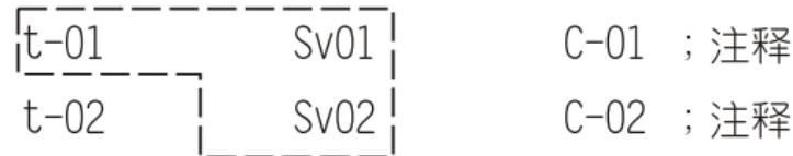
在t-01时间内从Sv01变化到Sv02，斜率=  $(Sv02 - Sv01) / t-01$ ，仪表正常工作时，SV将按照斜率细化整个控制过程，即在单位时间内逐步变化SV，在小范围内精细控制，使被控对象紧跟曲线，实现曲线拟合。用户可根据被控对象的不同状态，选择最佳的PID组。
