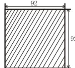
开孔尺寸 $92^{+1} \times 92^{+1}\text{mm}$
