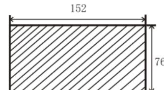
开孔尺寸 $152^{+1} \times 76^{+1}\text{mm}$
