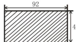
开孔尺寸 $92^{+1} \times 44^{+1}\text{mm}$
